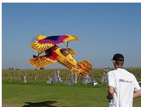
**Des avions de voltige sont de plus en plus gros et puissants**, permettant des évolutions acrobatiques dites en 3D, tel le torque roll, où un avion de 3 ou 4m d'envergure est suspendu verticalement à son hélice à quelques centimètres du sol, chose impossible en vol réel.
